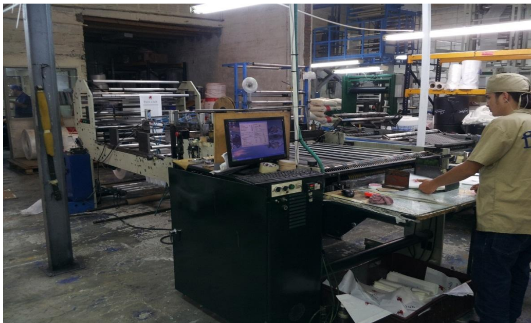
Figura 1. Maquina selladora de bolsas plásticos Tomada de la empresa IMPRESOS FLEXOGRAFICOS SAS.
