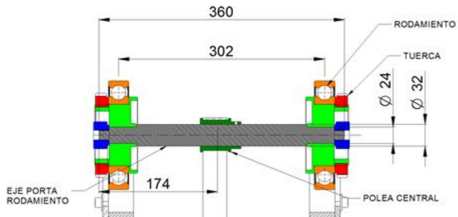
Figura 10. Medidas eje portarodamientos
