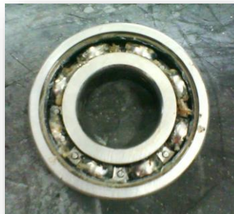
Figura 42 Rodamiento sin grasa
