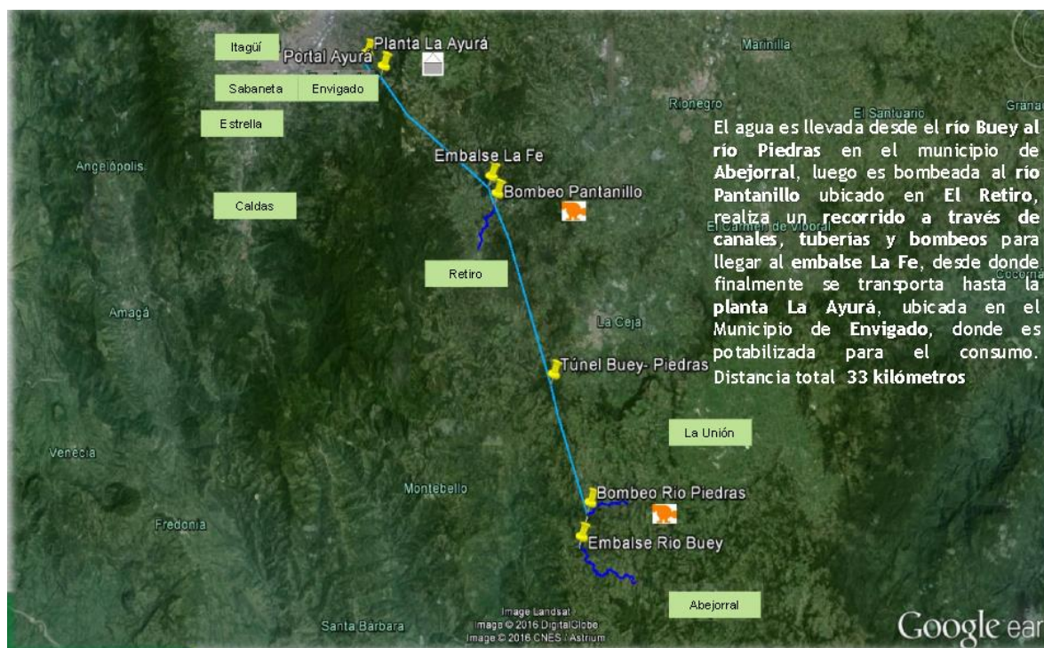
Figura 3. Desplazamiento del agua por tubería desde el bombeo Río Piedras.
