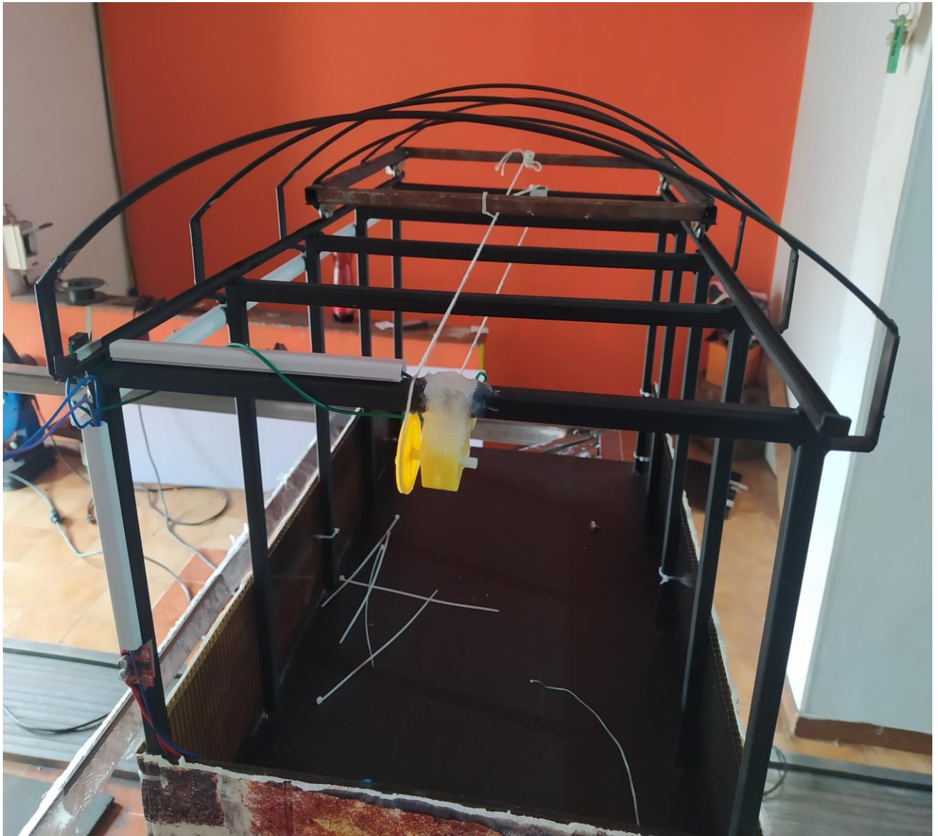
Figura 11. Guaya y motor que hacen mover el techo
