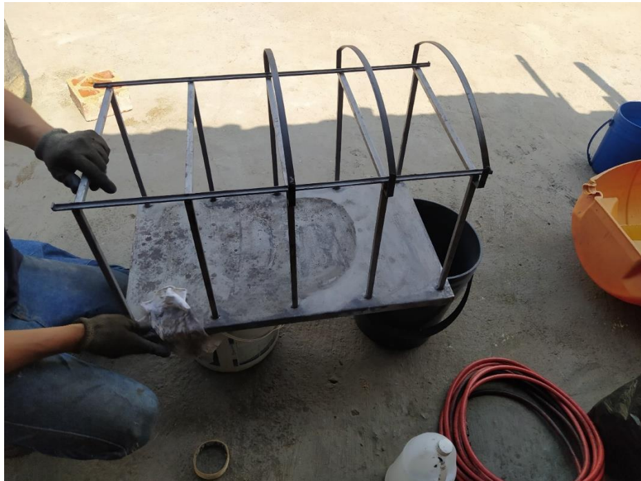
Figura 16. Incrustando los rieles en la estructura.
