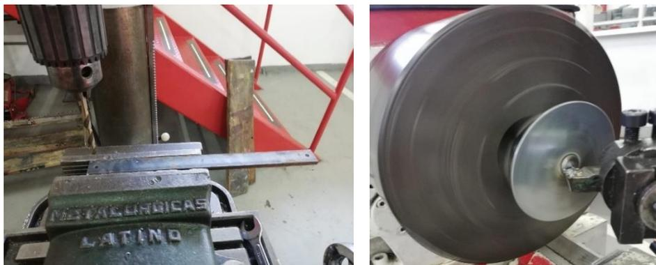
Figura 9. Proceso de perforado y torneado de piezas
