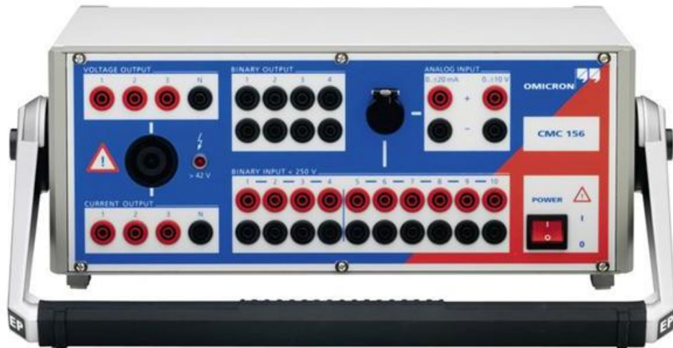
Figura 26. Equipo de inyección de relés. CMC 356 OMICRON
