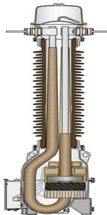
Figura 20. Transformador de corriente, vista sección
