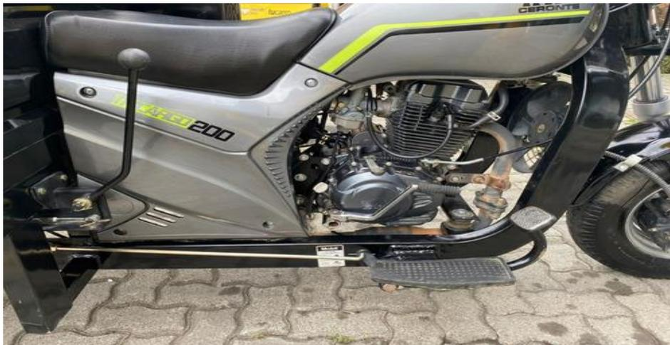
Figura 2. Motor de un motocarro
