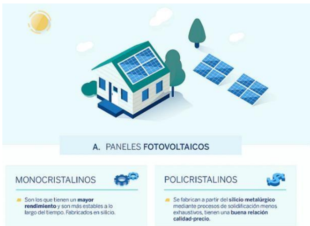
Figura 4. Tipos de paneles solares fotovoltaicos.
