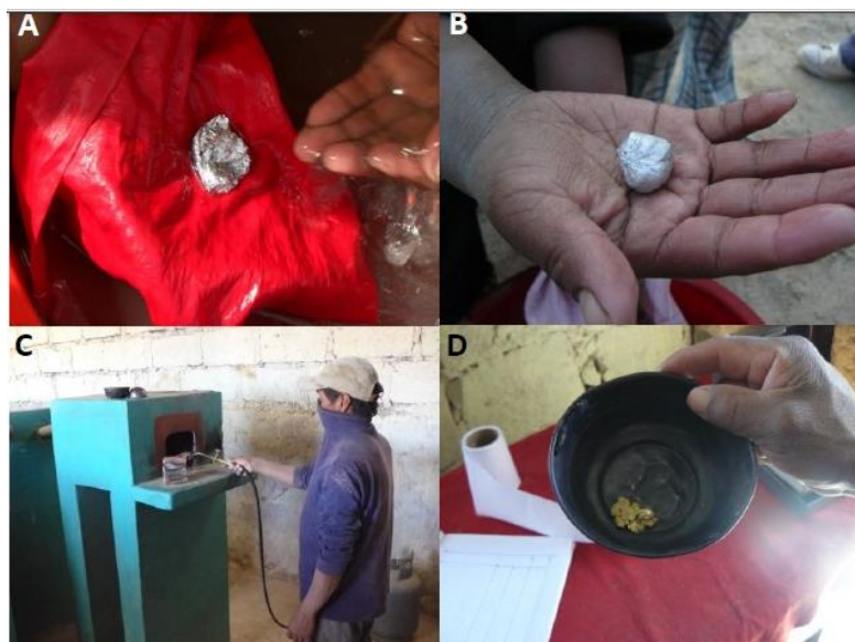
fig. 5 Proceso de amalgamación para la recuperación de oro A) Formación de amalgama B) Aspecto final de amalgama C) Refinación de la amalgama D) aspecto final del oro
