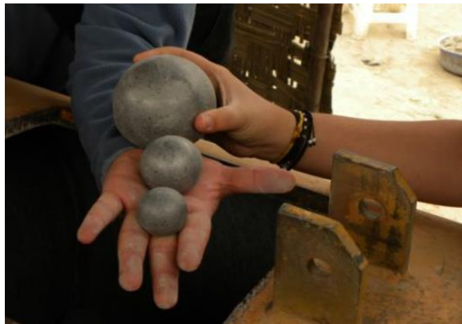
fig. 4 Bolas de acero del molino
