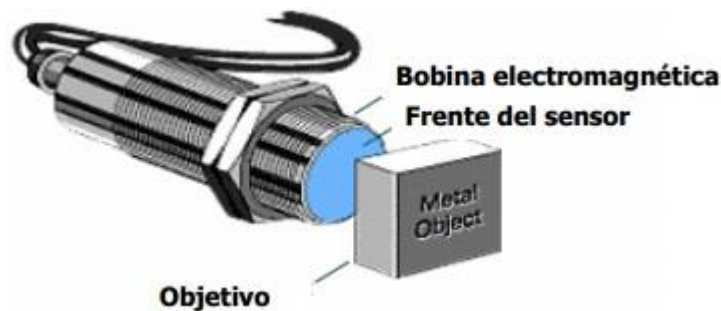
Ilustración 45. Bobina electromagnética y objeto metálico
