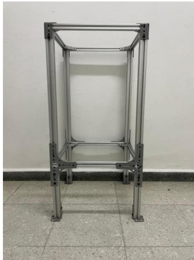
Figura 35. Estructura metálica pelador y picador de papa Fuente. Diseño propio
