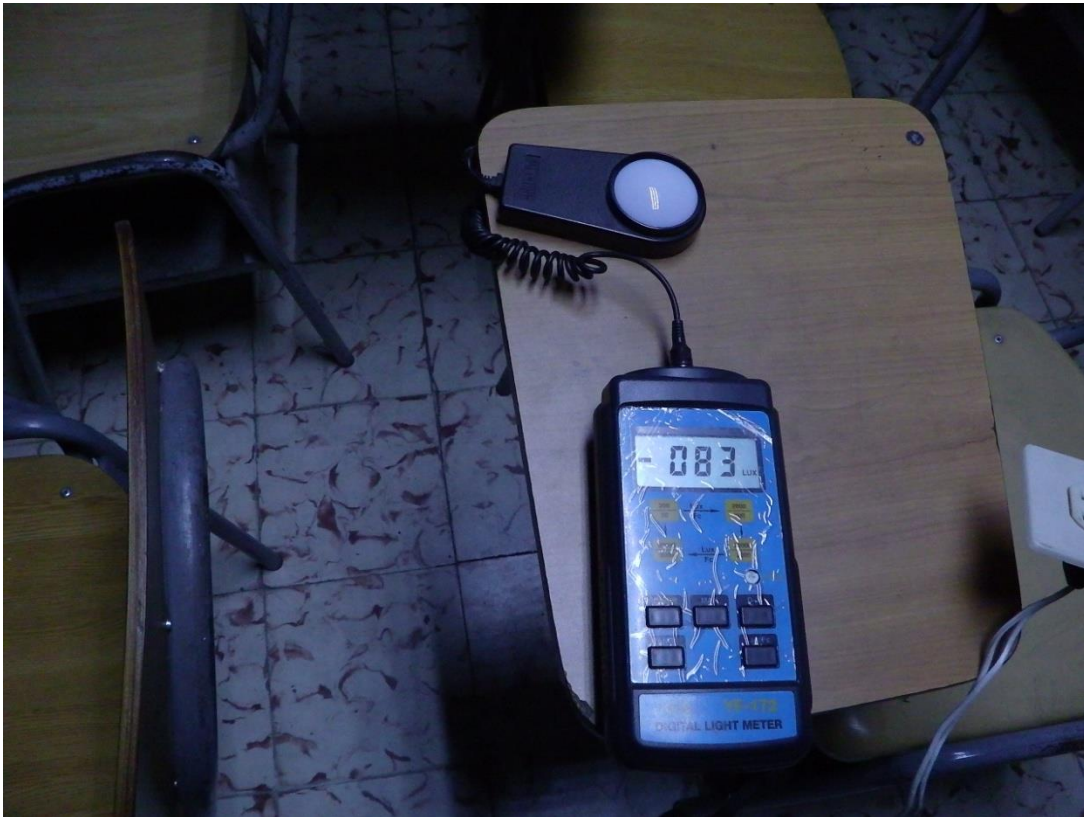
Figura 35. Medición con el luxómetro primer prototipo
