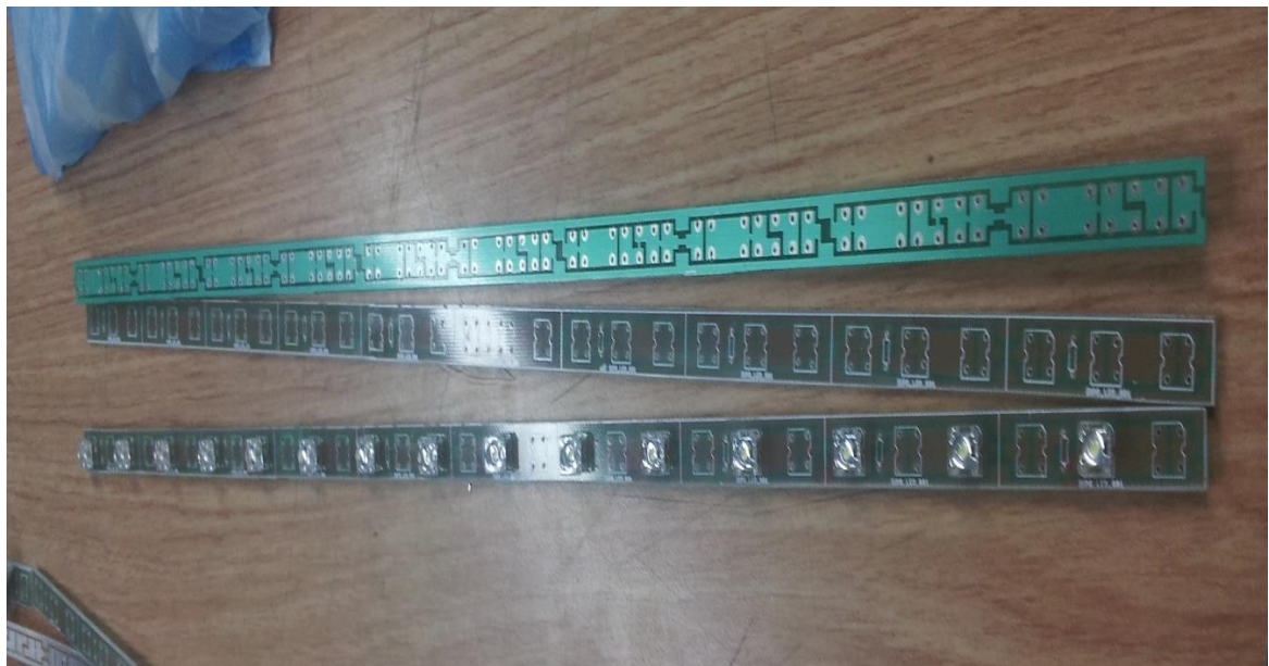
Figura 28. Circuito impreso en fibra de vidrio.
