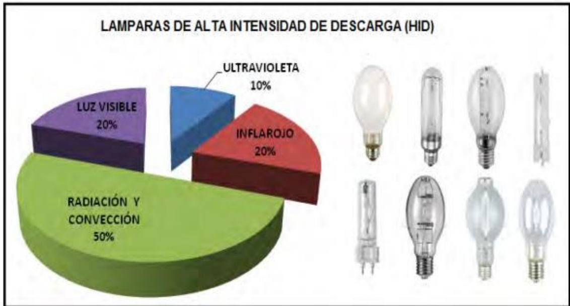
Figura 9. Porcentaje de radiaciones emitidas por las lámparas de alta intensidad de descarga.
