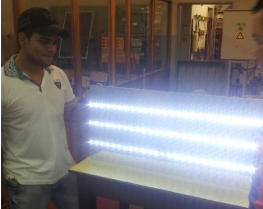
Figura 33. Distribución de las regletas en la lámina de aluminio con LED encendidos referencia LB ó SMD 5050
