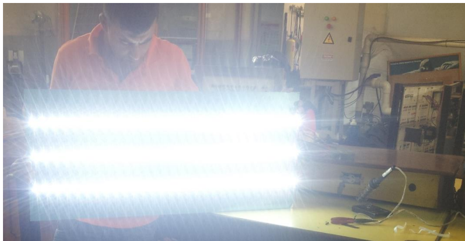
Figura 33. Distribución de las regletas en la lámina de aluminio con LED encendidos referencia LB ó SMD 5050
