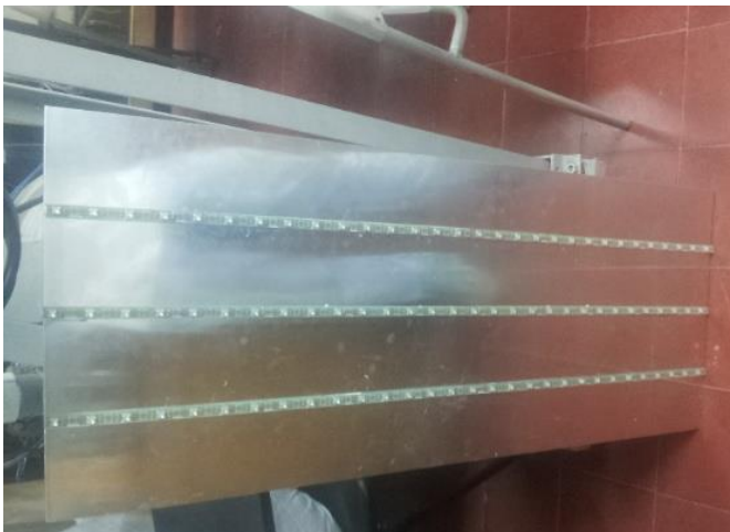
Figura 31. Distribución de las regletas en la lámina de aluminio LED LFBLA
