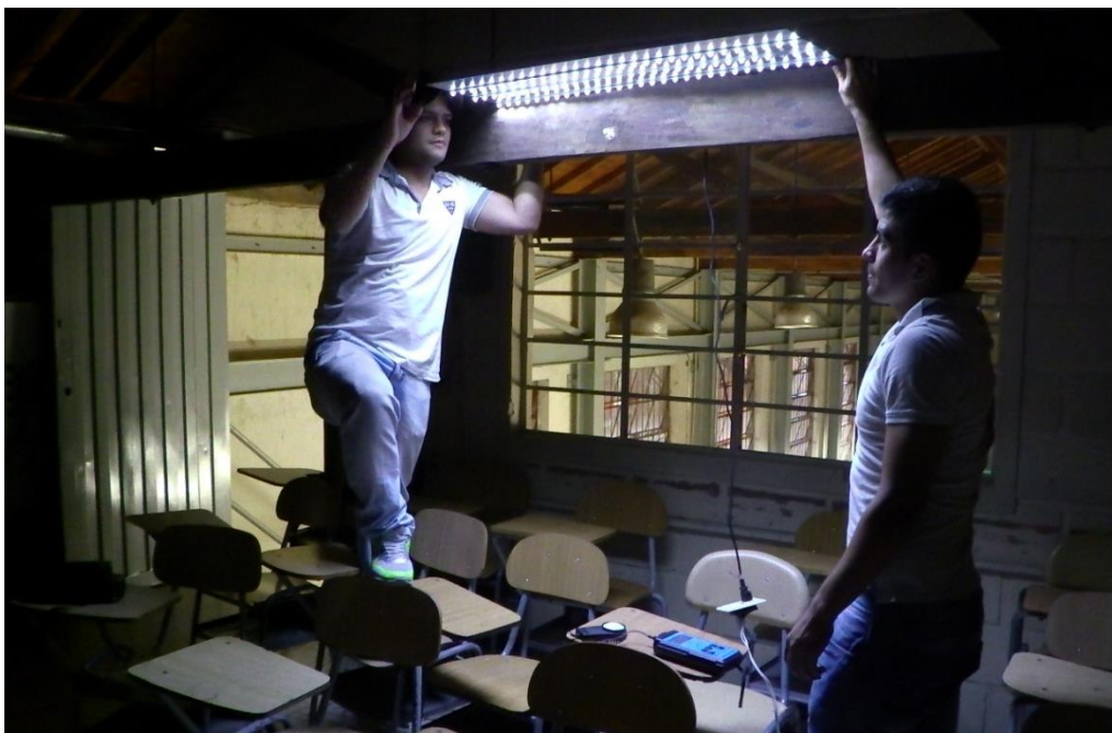
Figura 34. Medición prototipo de luminaria LED referencia LFBLA
