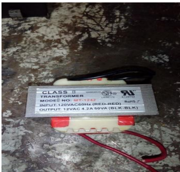
Figura 3. Transformador 110V-24V Fuente. Propia
