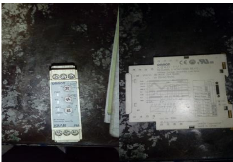
Figura 7. Relé monitor Fuente. Propia
