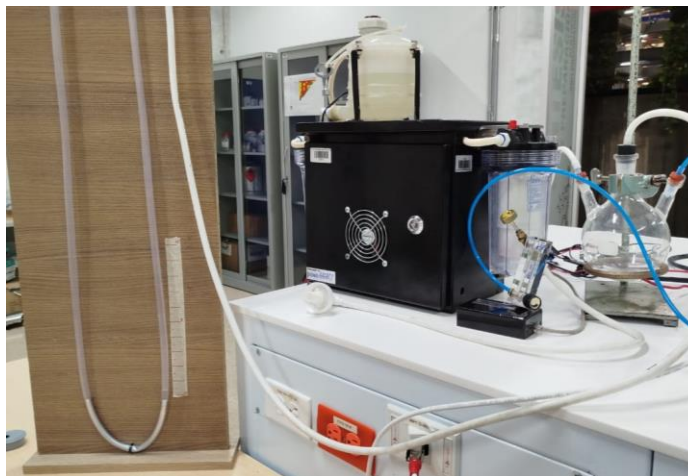
Figura 5: Celda electrolítica, equipos y montajes utilizados para las primeras mediciones
