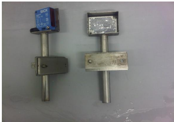
Figura 16. Sensor fotoeléctrico en soporte de acero inoxidable
