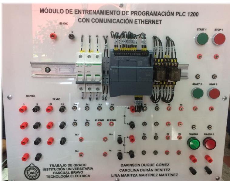
Anexo 3. Imagen delantera del módulo PLC terminado
