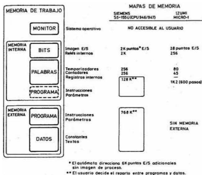
Figura 19. Estructura típica de un mapa de memoria y ejemplos.
