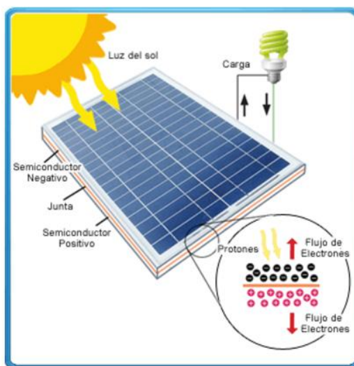
Figura 4. Características de un panel solar.
