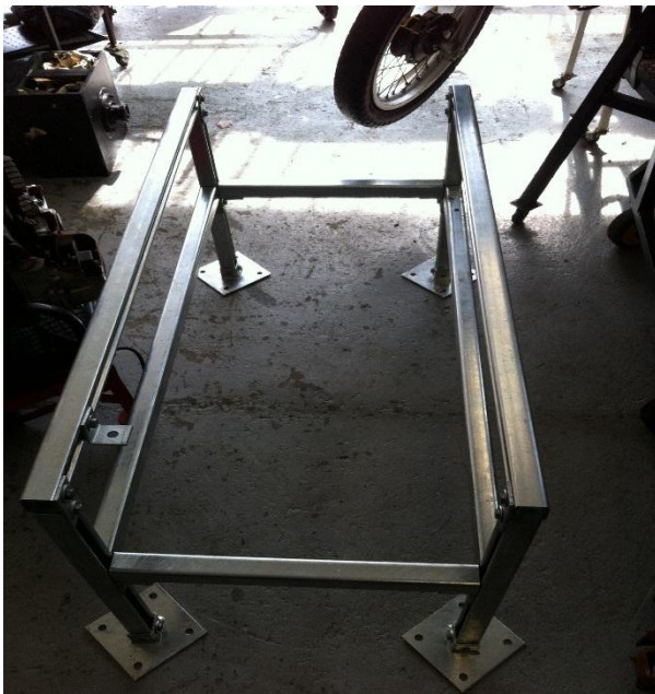
Figura 18 Estructura que soporta el motor diésel y el generador (Fotografía propia)
