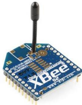
*Figura 3.* XBee serie 2
