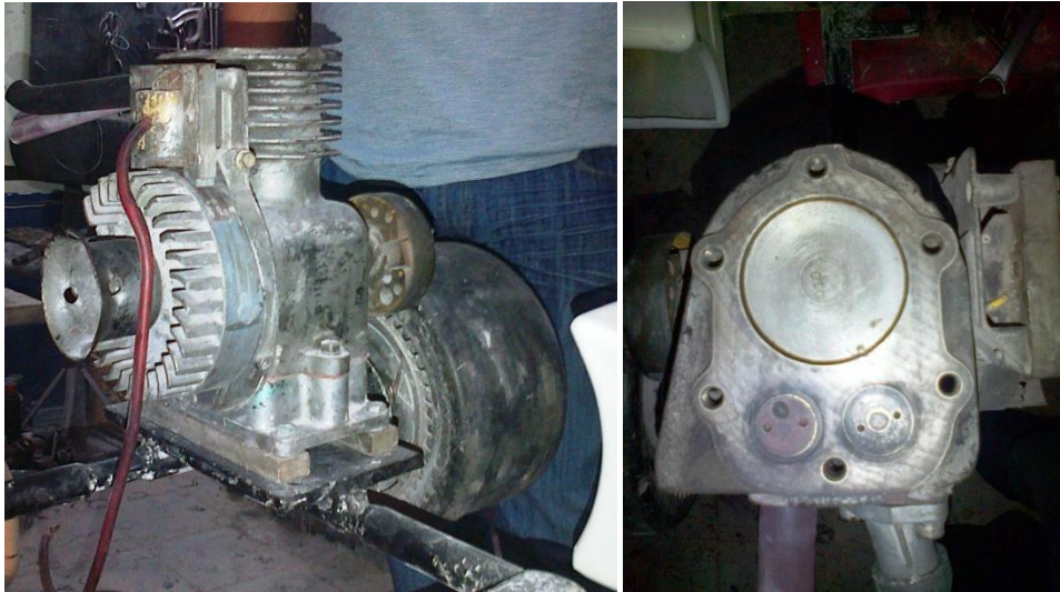
Figura 33: Fotografías Motor Estacionario Simil Honda, en proceso de mejoramiento e instalación
