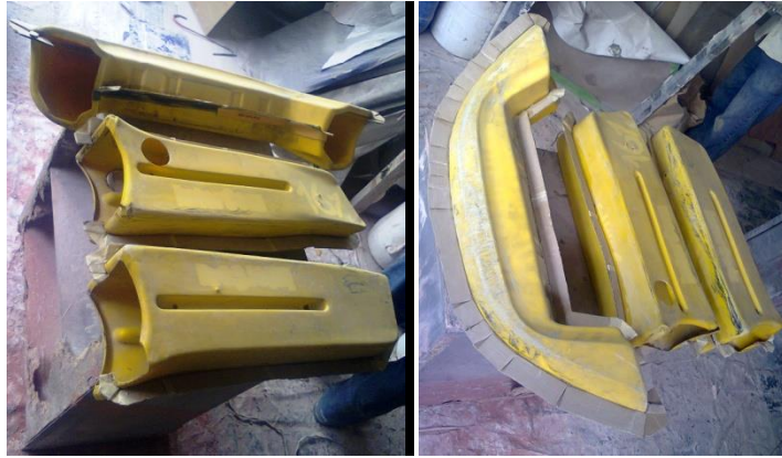
Figura 36. Fotografías del Bumper delantero y laterales del Kart, hechos en fibra de vidrio.
