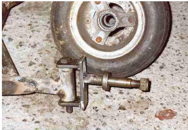
Figura 17: Fotografía de pivote y yugo, con rueda.
