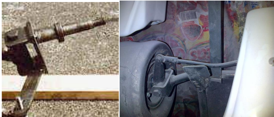
Figura 24: Yugo de rueda y brazo de dirección.
