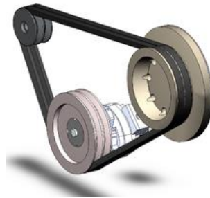
Figura 7: Imagen Transmisión por Polea, Correa de transmisión entre distintas poleas.
