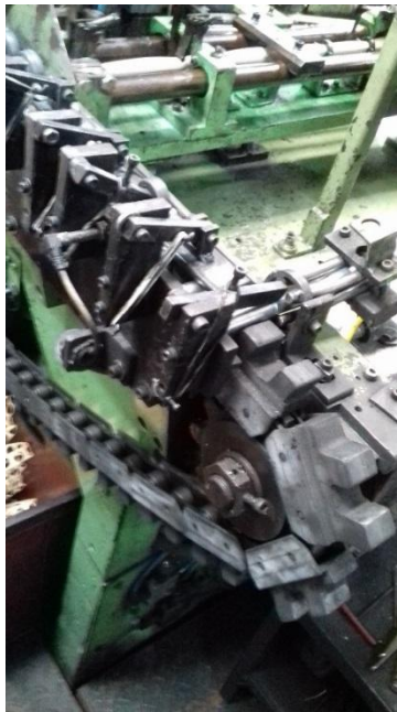
Figura 5. Se encargada de llevar en cada uno de los cangelones una unidad, (Cadena transportadora).
