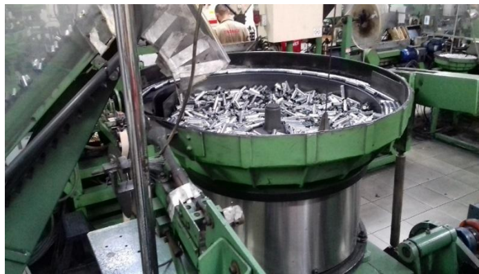
Figura 3. Posiciona los vasos para enviarlos al tobogán, (Vibrador de vasos).
