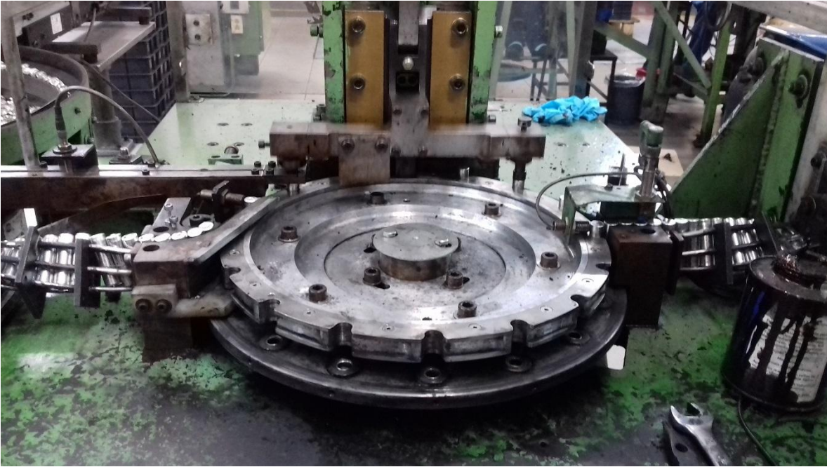
Figura 19. El nuevo diseño de insertadora de discos de fondo, de la maquina bottom, (línea R06).
