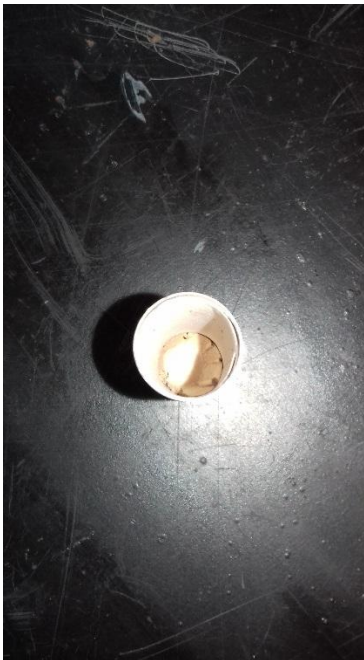
Figura 7. Podemos observar el vaso de zinc con el papel electrolítico a los lados y en el fondo, (Vaso de zinc).
