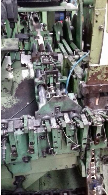
Figura 6.: Es donde se pone el papel electrolítico en la en la pared del vaso, (Estación de papel electrolítico).
