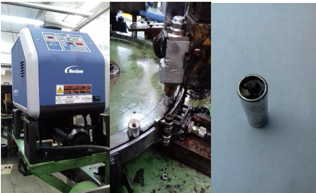
Figura 13. Esta inyecta brea a 90° para el sellado, (Selladora).
