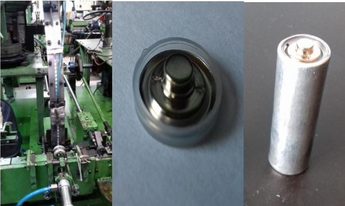
Figura 14. Coloca una tapa metálica y se hace un rebordeo del vaso ver figura., (estaciones discos de sello).
