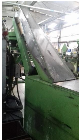
Figura 1. Parte encargada de transportar los vasos de la tolva al vibrador (Jirafa).
