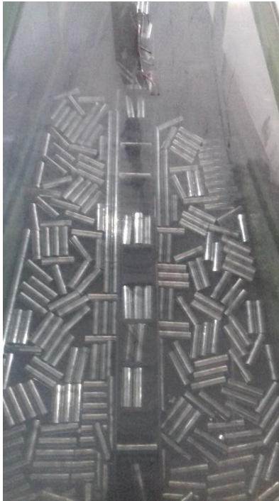
Figura 2. Encargada de transportar los vasos de la tolva al vibrador, (Banda transportadora).
