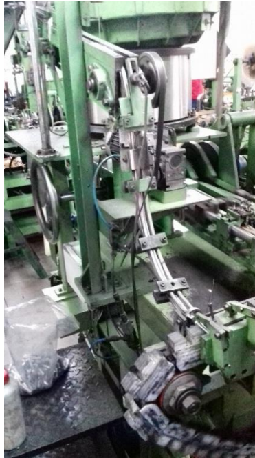
Figura 4. Es el encargado de colocar los vasos en la cangelones de la cadena, (Tobogán).
