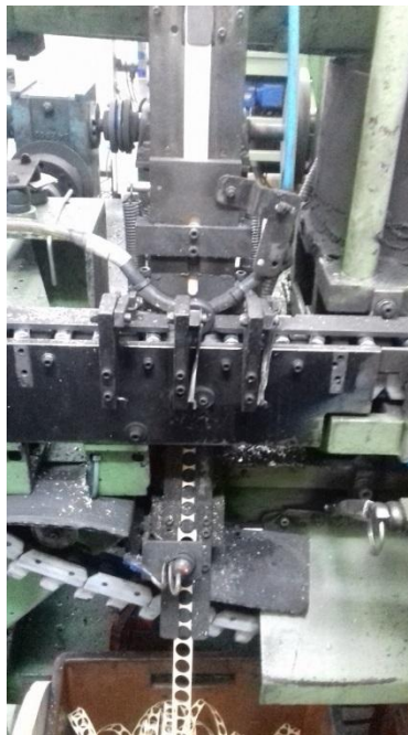
Figura 11. Es el encargado de cortar una arandela de cartón y ayudar a la compactación de la celda, (Troqueles de compactación).
