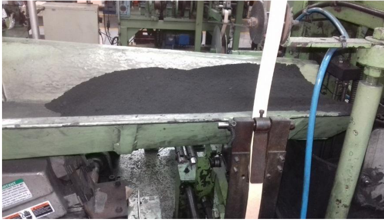
Figura 8. Es la encargada de mantener el depósito de mezcla lleno, (Vibrador de mezcla).
