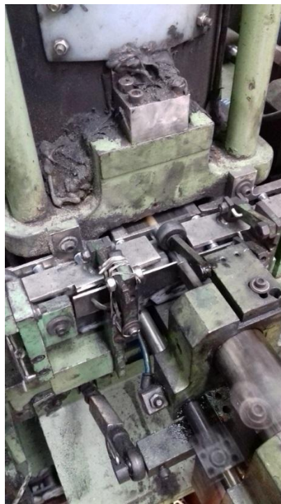
Figura 9. Es la encargada de llenar el vaso de mezcla, (Estación de inyección de mezcla).
