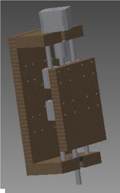
Figura 43 Diseño de sistema de desplazamientos para el eje Z
