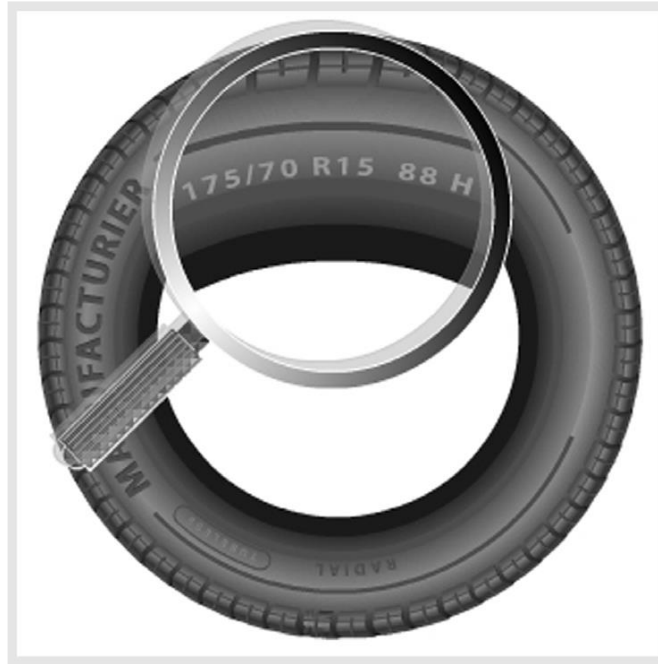
Figura 29. El marcado normalizado de un neumático.
