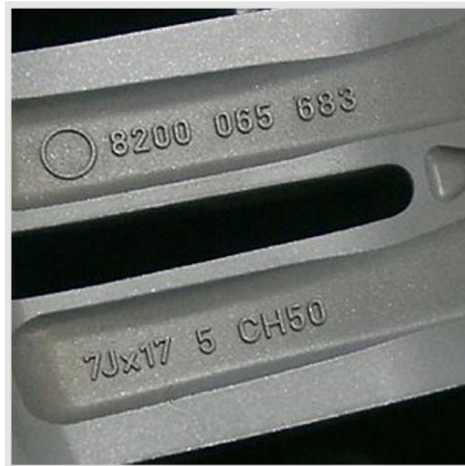
Figura 30. Marcado normalizado de una llanta.
