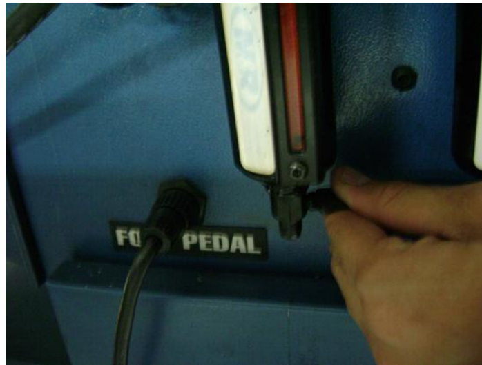
Figura 14. Válvula de purga unidad de mantenimiento
