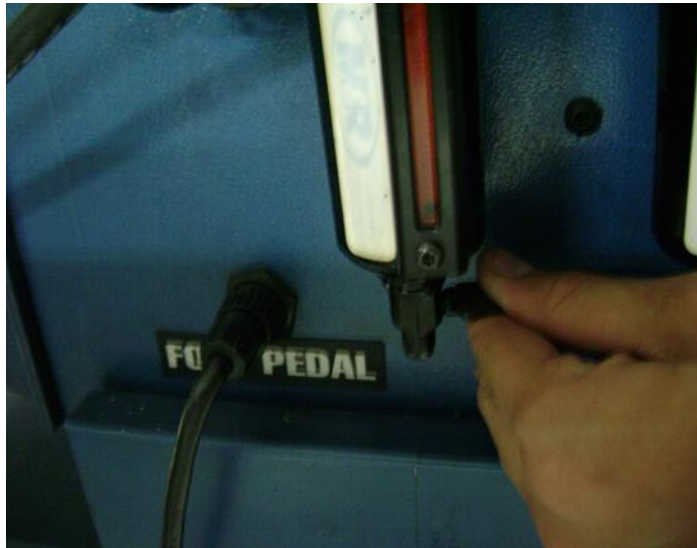
Figura 22. Válvula purga unidad de mantenimiento
