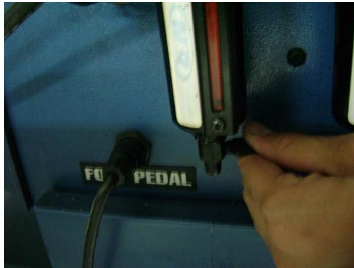
Figura 9. Válvula de purga unidad de mantenimiento
