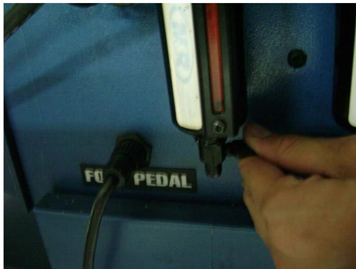
Figura 18. Válvula purga unidad de mantenimiento
