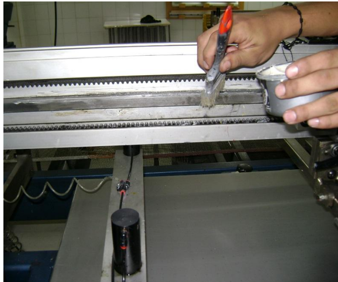
Figura 11. Pista de rodadura carro de impresión. Vista posterior
