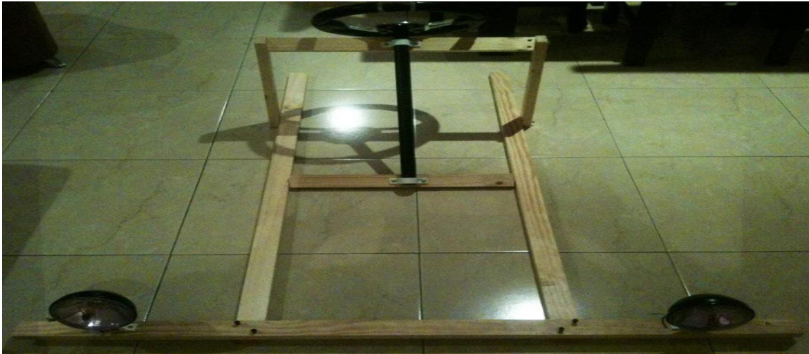
Figura 25. Montaje de los faros.
