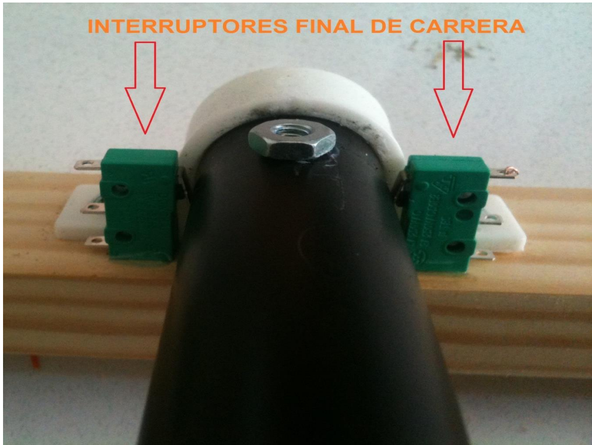
Figura 28. Instalación interruptores final de carrera.
