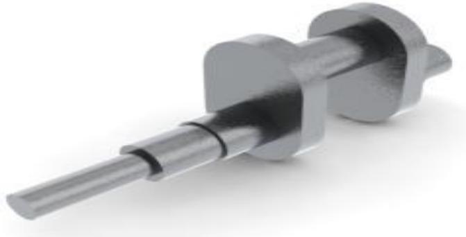
FIGURA 18 Modelado Masa de la Manivela
