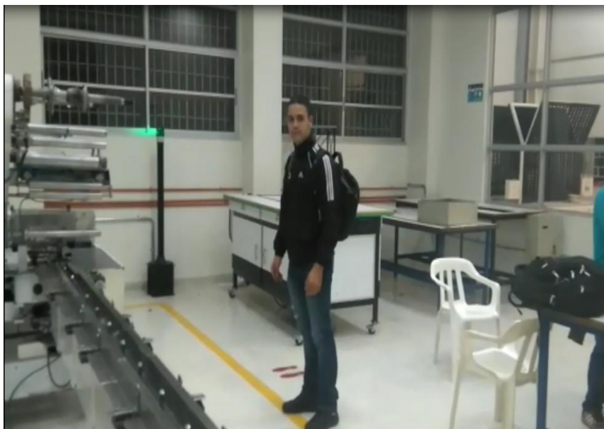
Figura 25. Invasión de la línea de señalización para evitar el paso hacia la máquina
