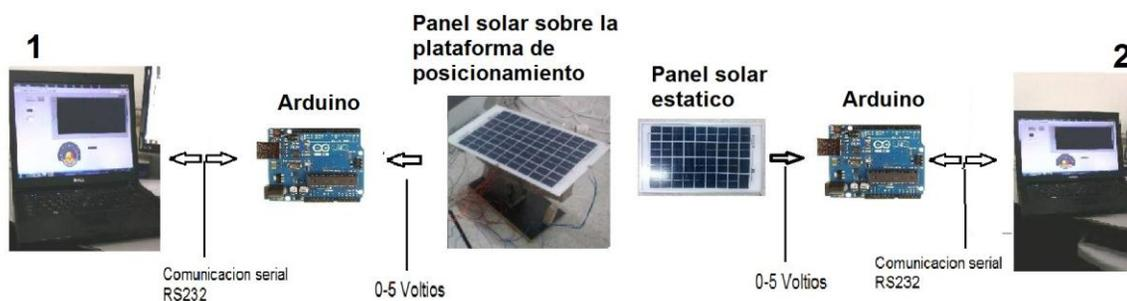
Figura 15. Sistema de adquisición de datos
