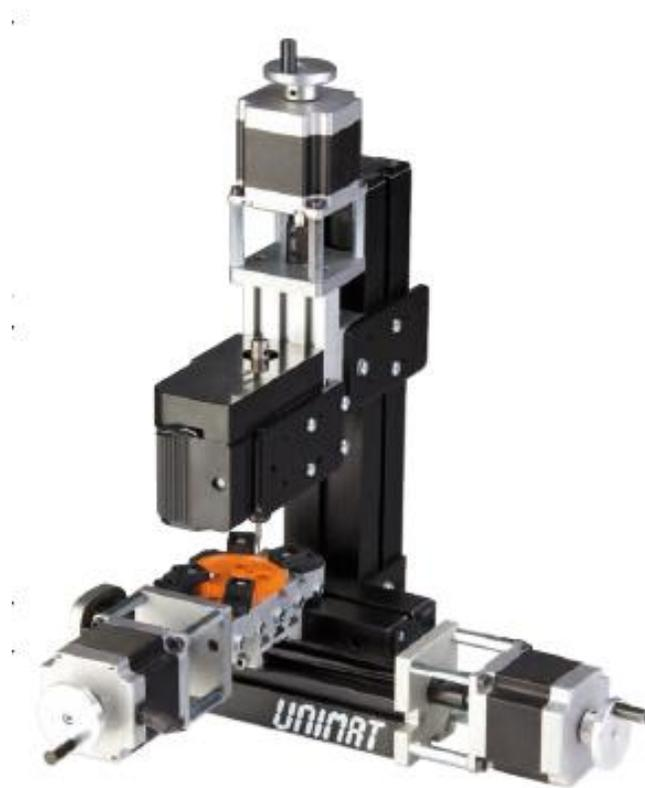
*Figura 4* Fresadora controlada mediante CNC.
