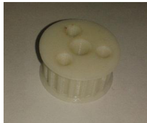
Figura 36. Polea conductora o motriz en plástico ABS
