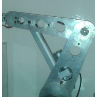
Figura 38. Actuador eléctrico encargado del movimiento del codo del robot.
