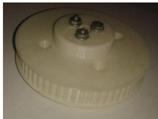
Figura 37. Polea conducida impresa en 3D con bioplástico degradable ABS
