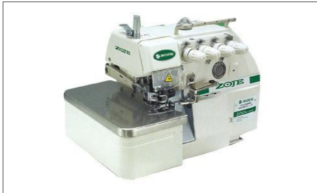
Figura 9. Maquina Industrial Fileteadora
