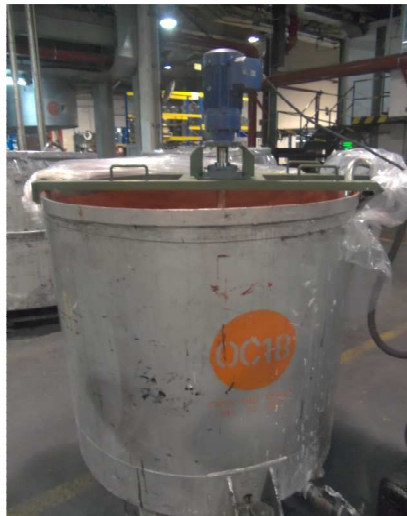
Imagen 19: Sistema de recirculación con agitador neumático
