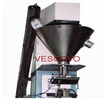
Imagen 6. Dosificador a tornillo y balanza.
