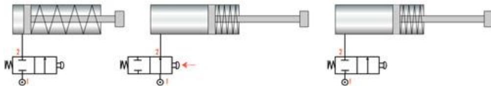
Figura 26. Cilindro simple efecto gobernado con una válvula 2/2
