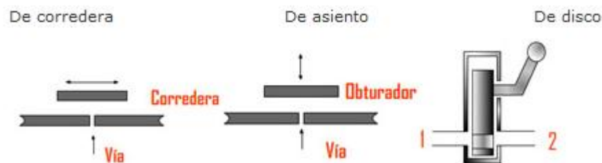
Figura 18. Clasificación de las válvulas en función de su construcción interna
