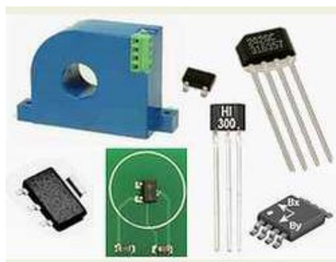
Foto 8. Sensores contruidos en una cápsula de tipo circuito integrado
