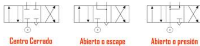
Figura 56. Válvulas de 3 posiciones y 4 vías
