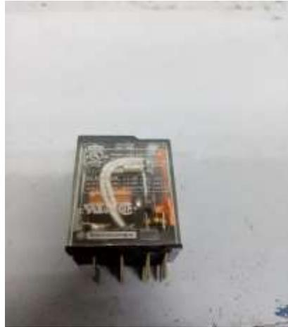
*Figura 18.* Relé electromecánico
