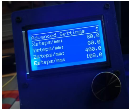
Figura 74. Nuevos valores en los pasos de la máquina. Fuente: diseño propio
