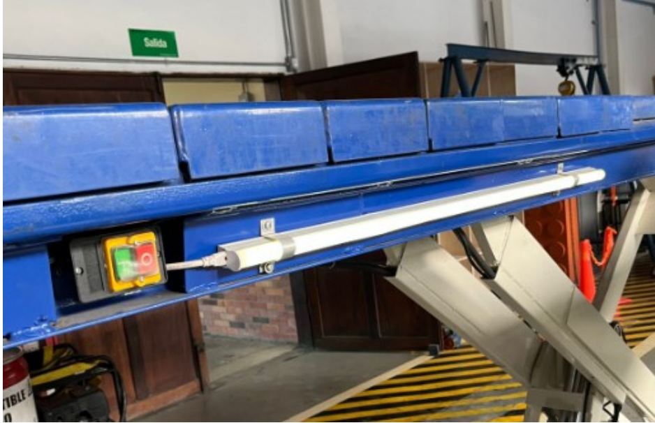
Figura 6. Conexiones de iluminación.
