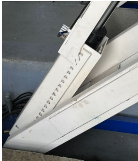
Figura 10. Sistema de bloqueo de seguridad.
