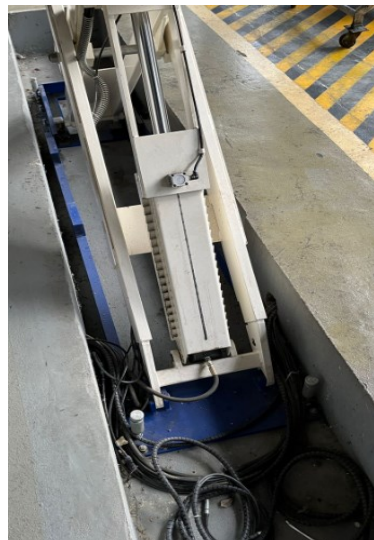
Figura 9. Cilindro hidráulico y mangueras.
