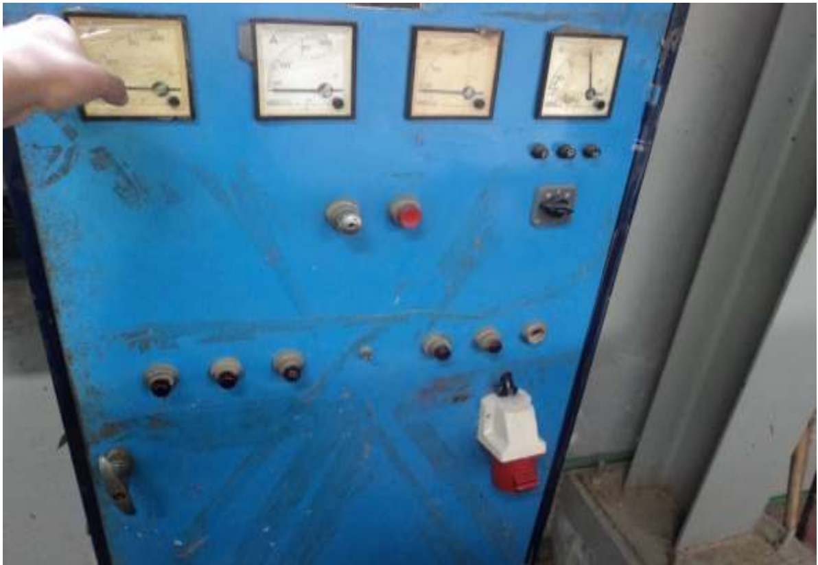
Gráfico 11. Fuente de alimentacion del módulo
