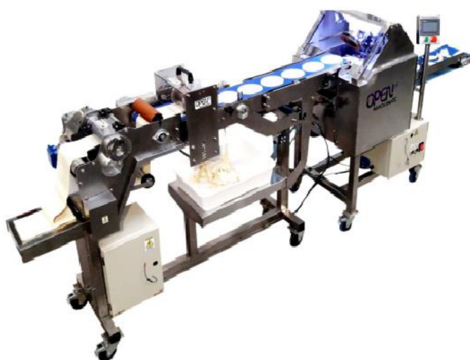
Ilustración 8. Maquina semiautomática para producir empanadas armadora modelo msa160ct
