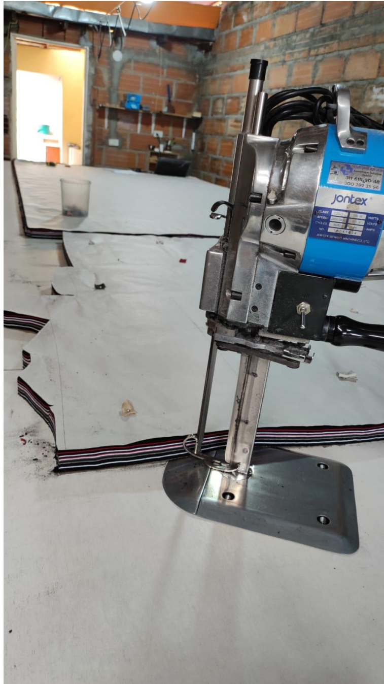
Ilustración 1. Herramientas o equipos (cortadora vertical)
