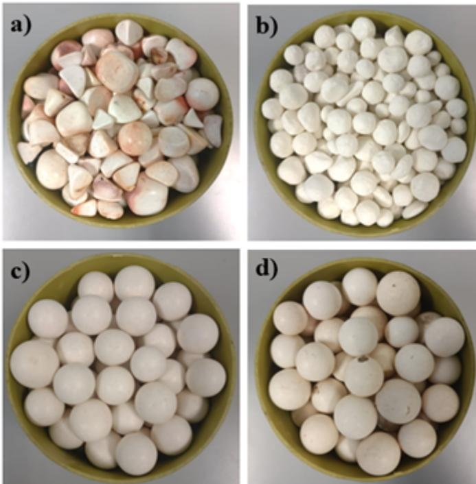
Las bolas son utilizadas en diversas aplicaciones industriales debido a sus propiedades térmicas. Son un buen conductor térmico, capaces de transferir calor eficiente en comparación con otros materiales cerámicos, tienen una buena capacidad térmica, pueden almacenar una cantidad significativa de calor por unidad de masa, soportan temperaturas superiores a 1600 °C,
