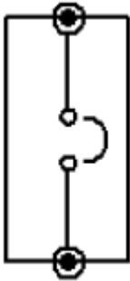
Medidor de energía
