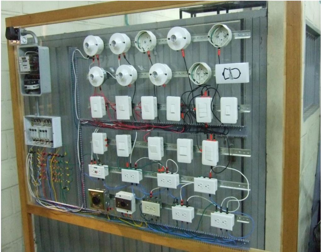
Figura 47. Modulo didáctico de instalaciones eléctricas en etapa final.
