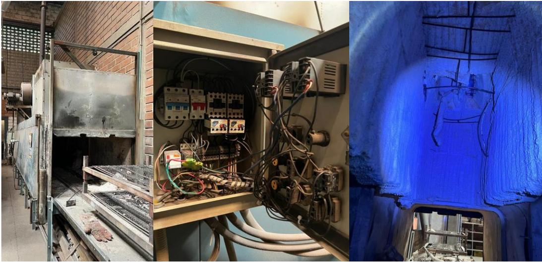
*Figura 1.* Horno discontinuo antiguo, para el quemado de material antiadherente (PTFE).
