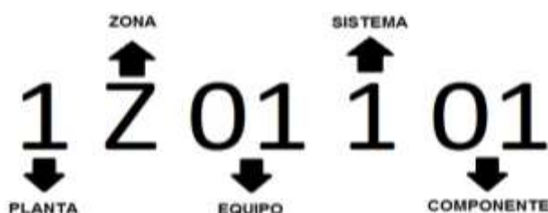
Figura 2: Codificación de los equipos.
