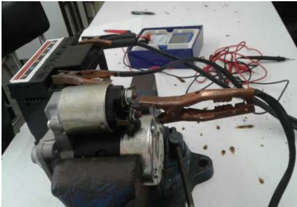
Figura 12 Pruebas con arrancadores Fuente. Propia
