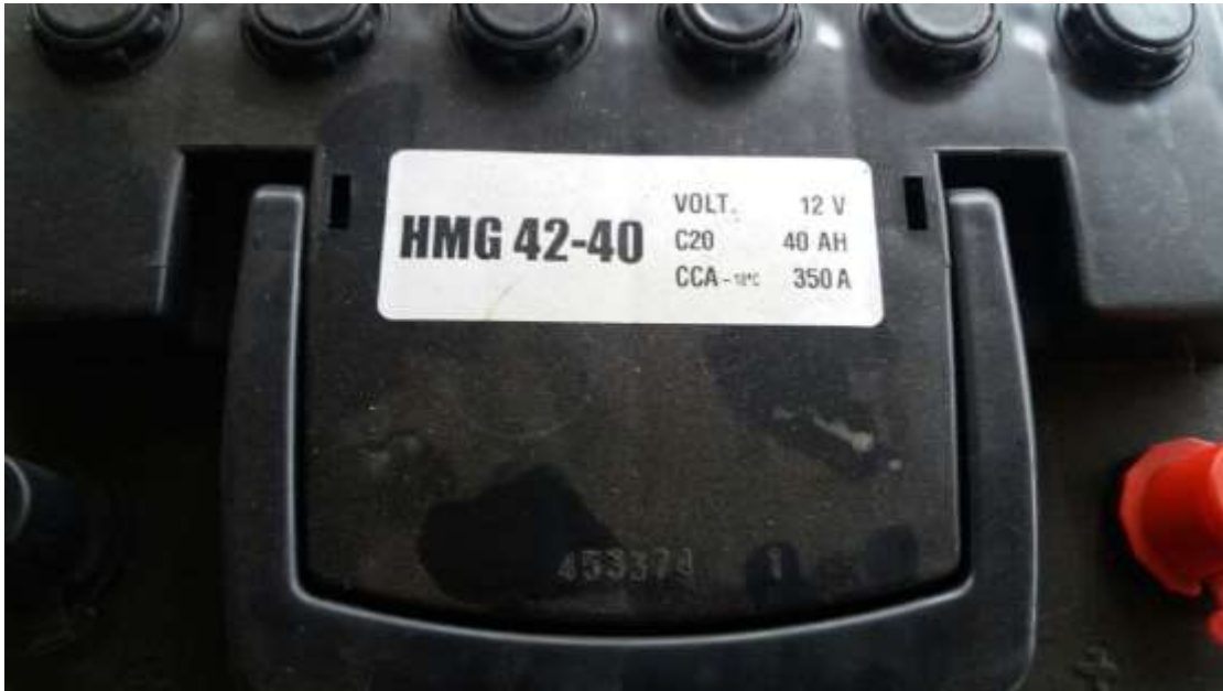
Figura 22 Datos de placa de la Batería HMG Fuente. Propia
