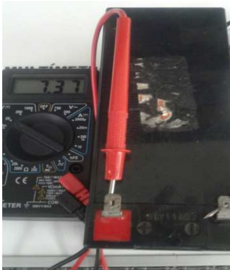
Figura 13 Verificación de voltaje Fuente. Propia
