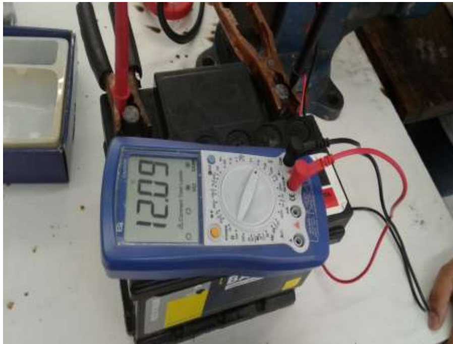
Figura 10 Verificación de voltaje Fuente. Propia
