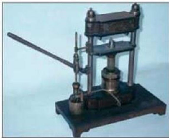
Prensa de fricción para estampar de principios del siglo XX. Catálogo General de Máquinas-Herramientas 1913 Alfred H. Schütte
