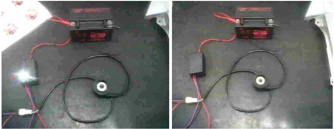
Figura 20. Sensor en buen estado
