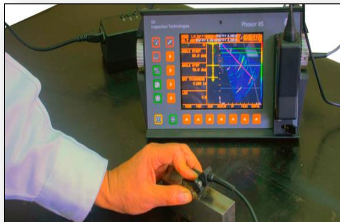
Foto 4. Inspección de materiales con ultrasonido industrial.
