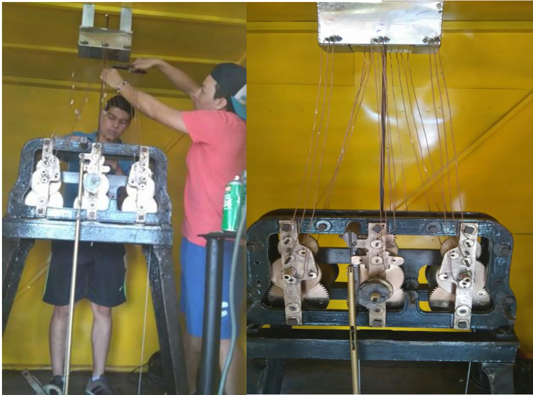
Figura 24. Instalación del sistema de lubricación por goteo
