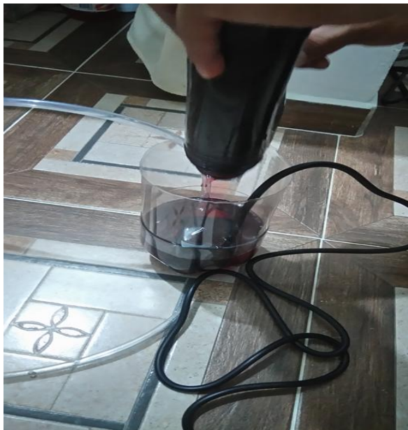
Figura 15. Suministro del aceite lubricante a través de la bomba
