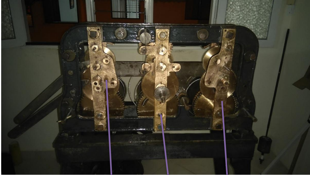
Figura 23. Detalle de los bloques en donde se instalarán los capilares
