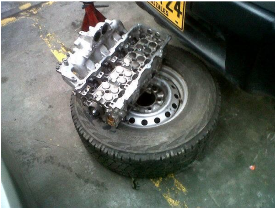
Grafica 1: Calibración de monedas de la culata. (Nissan Frontier).
