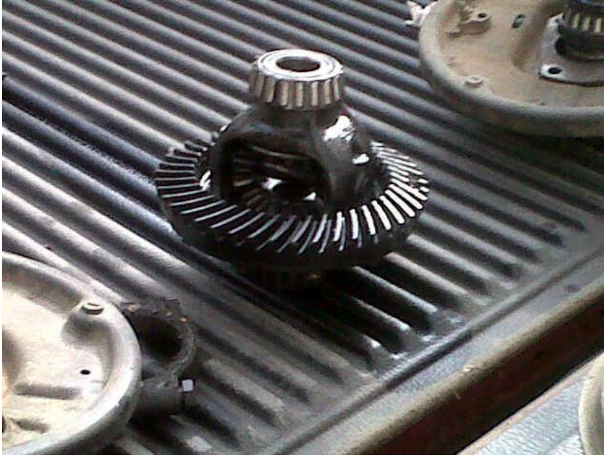
Grafica 4: Reparación de planetarios, retenedores y rodamientos. (Luv Dmax).
