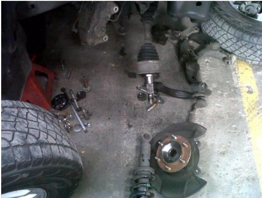
Grafica 9: Cambio de: esferas, terminales de dirección, ejes, retenedores, engrase de rodamientos, cambio de discos. (Toyota Prado).
