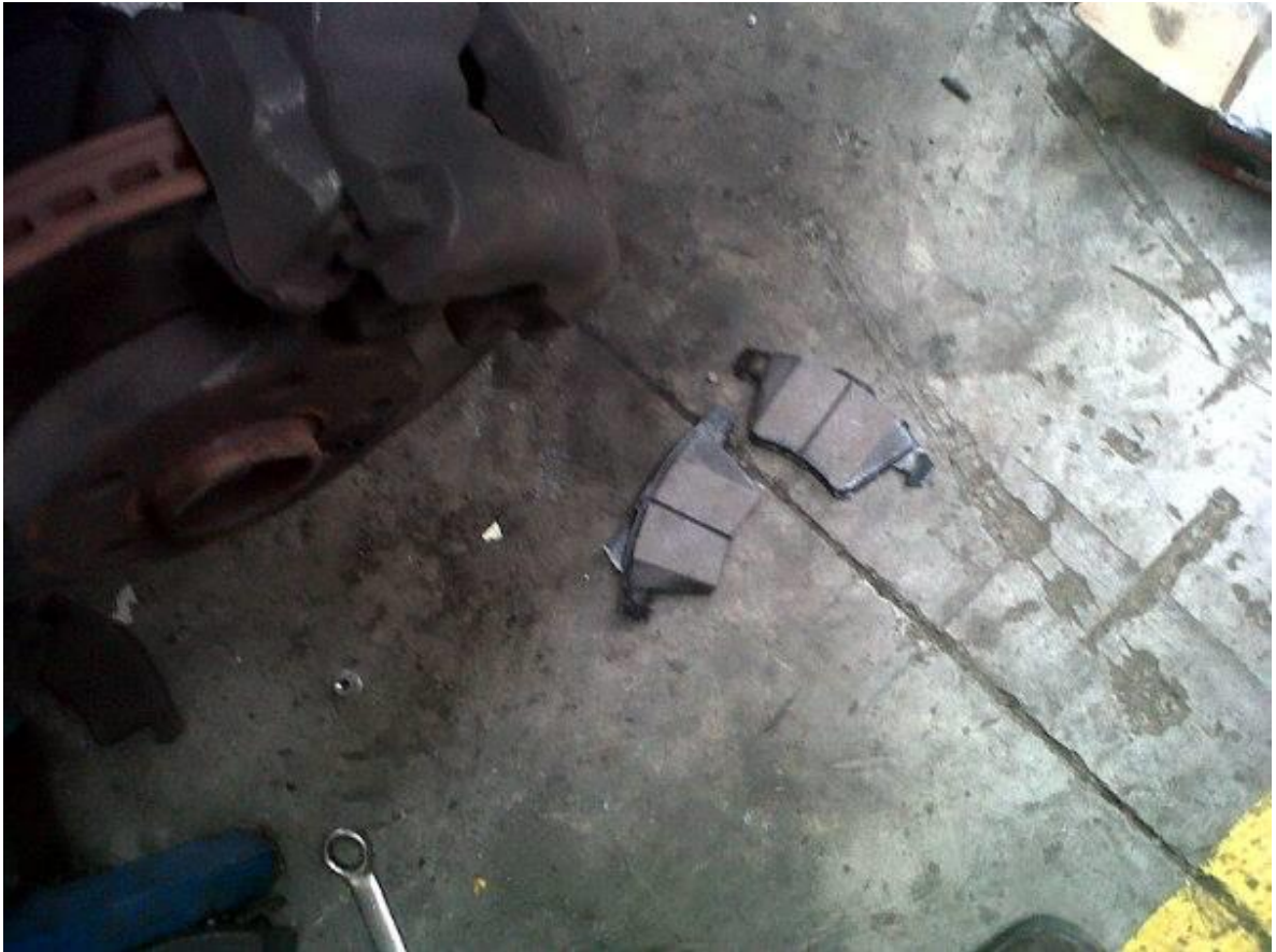
Grafico 8: Cambio pastillas de frenos. (Toyota Prado).
