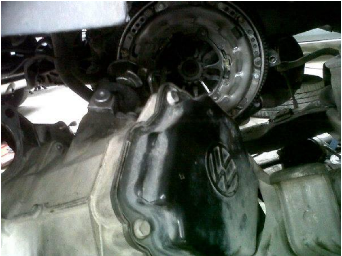
Grafica 6: Reparación de embrague, retenedores, monte y desmonte caja de velocidades mecánica. (Volkswagen Aerovan).
