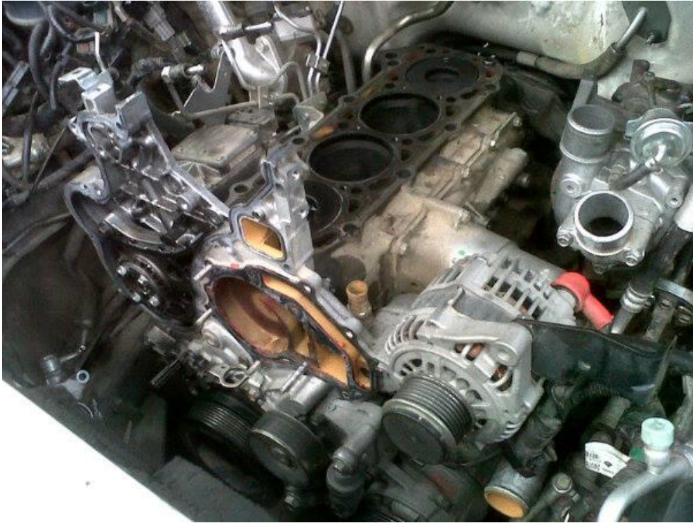
Grafica 2: Cambio de empaque de culata, turbo y pistones. (Nissan Frontier).
